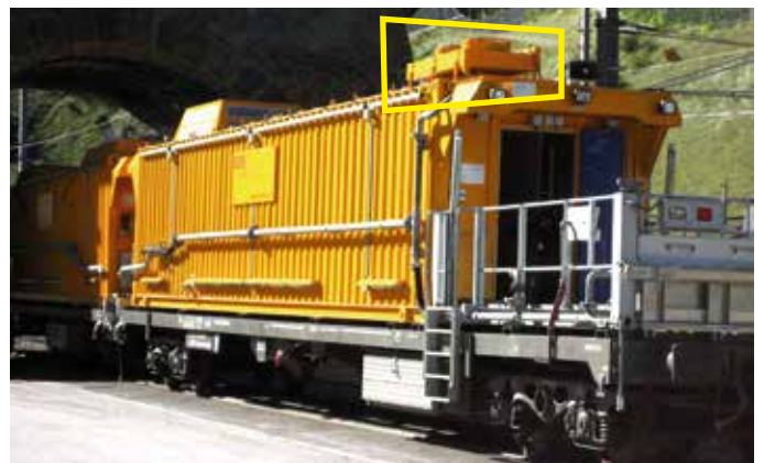
Separate Montage des Kühlers auf dem Dach des Waggons
