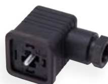
3-polige Leistungssteckdose mit Zentralschraube M 3 x 35 nach DIN EN 175301-803-A
