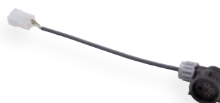
Konfektioniertes Kabel Typ FL33X33X 3 x 0,75 mm 2 mit 3-poligem Bajonettstecker 16 S Winkel 90°
