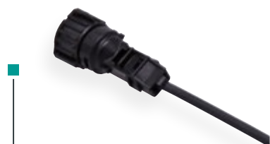
Konfektioniertes Kabel Typ FL33X33X 3 x 0,75 mm 2 mit 4-poligem Bajonettstecker ISO 15170 gerade
