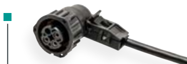
Konfektioniertes Kabel Typ CL105 3 x 0,75 mm² mit 4-poligen Bajonettstecker ISO 15170 Winkel 90°
