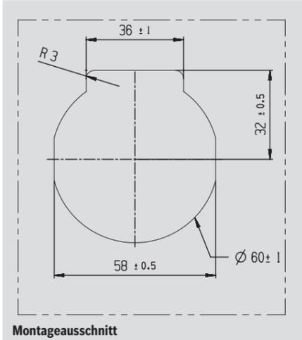
Beachten Sie, dass unterhalb des Montageausschnitts genug Raum für die Versenkung der Ladestation und deren Verkabelung besteht.
