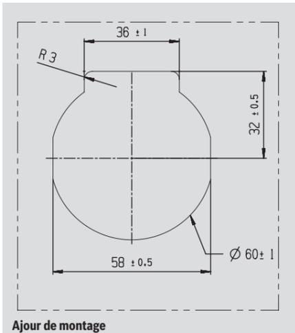
Veillez à disposer de suffisamment de place en-dessous de l'ajour de montage pour insérer le chargeur et ses câbles. Le fabricant du véhicule est tenu de respecter les dispositions légales.
